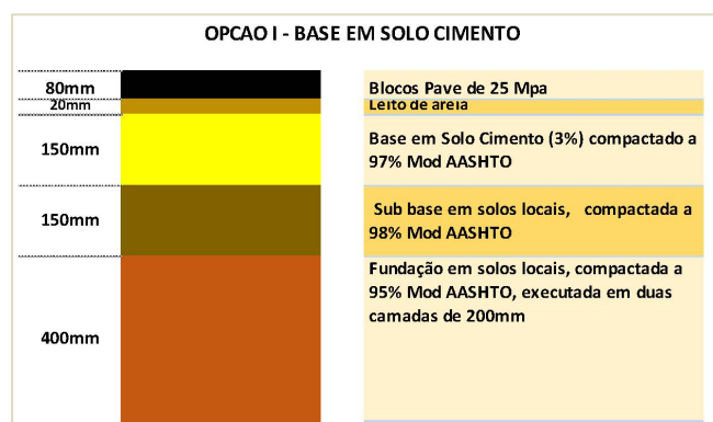
Figura 6-2. Estrutura do pavimento recomendada
